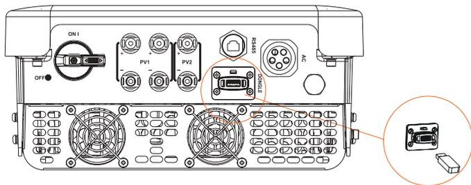
3) A continuación, introduzca el disco en U en el puerto DONGLE de la parte inferior del inversor. Después, encienda el interruptor de CC y conecte el conector FV, la pantalla LCD mostrará una imagen como la siguiente.
